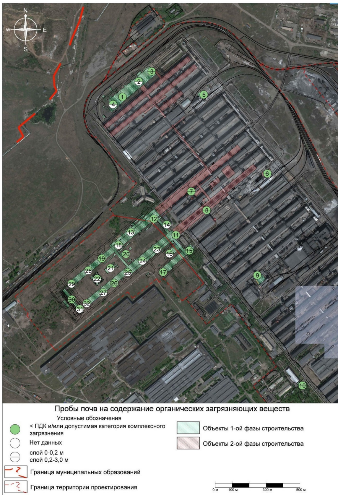
Рисунок 3.5.1-3. Карта-схема загрязнения ТПО и грунтов производственной площадки АО «РУСАЛ Красноярск» органическими загрязняющими веществами
