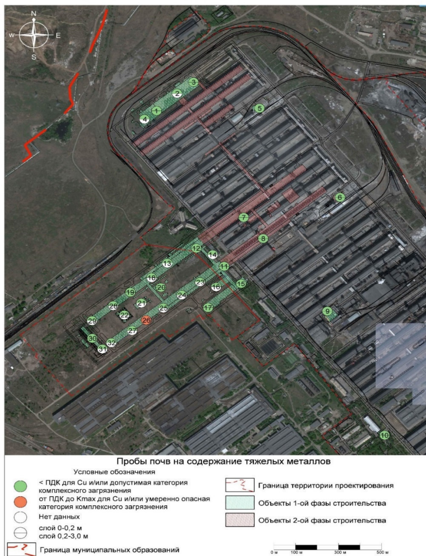
Рисунок 3.5.1-1. Карта-схема загрязнения ТПО и грунтов производственной площадки АО «РУСАЛ Красноярск» тяжелыми металлами
